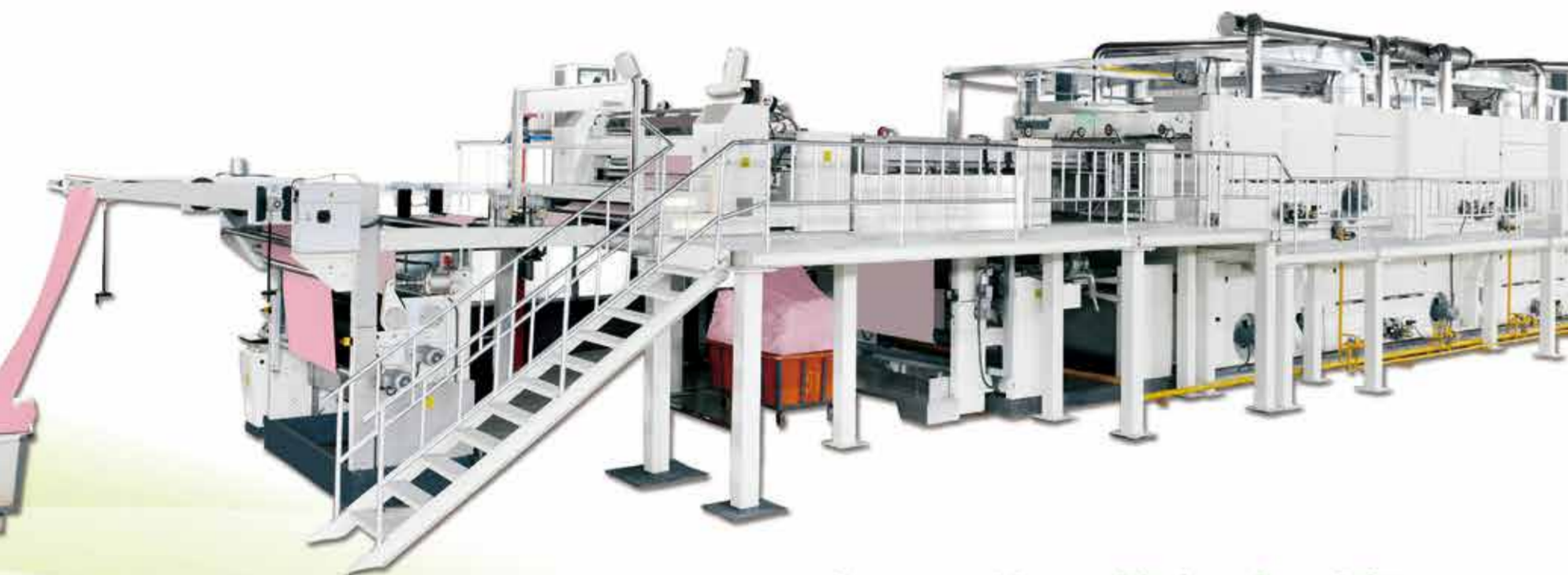
Y9000型双层热风拉幅定形机
