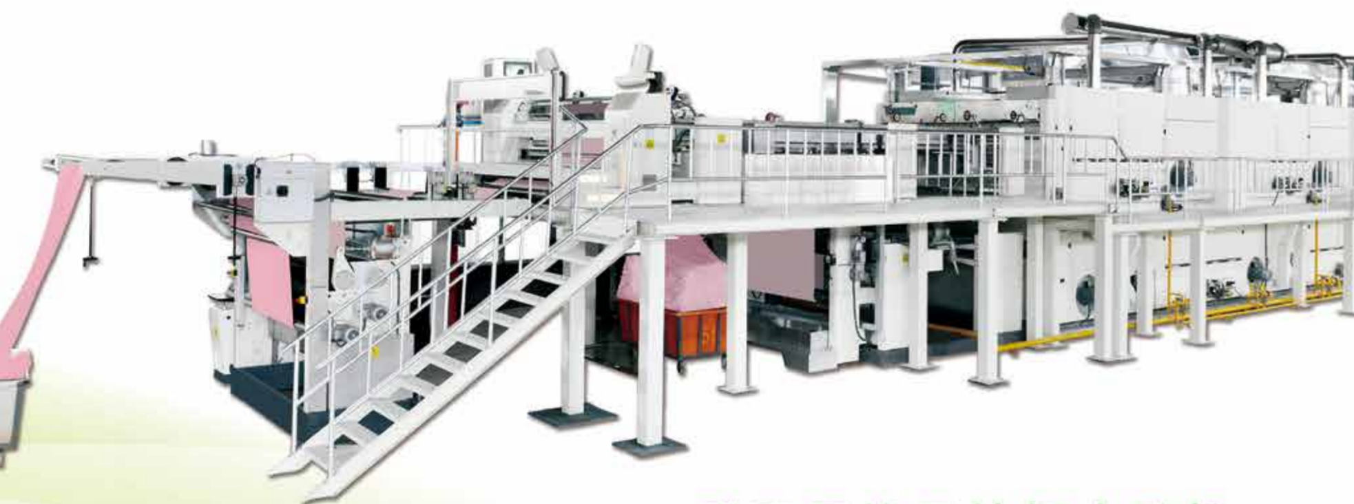
Y9000型双层热风拉幅定形机
