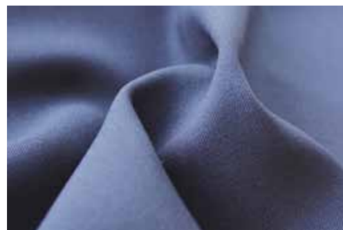
100%PET 塑料瓶再生纤维斜纹面料,不同染色的杂色调能使风格产生变化。
