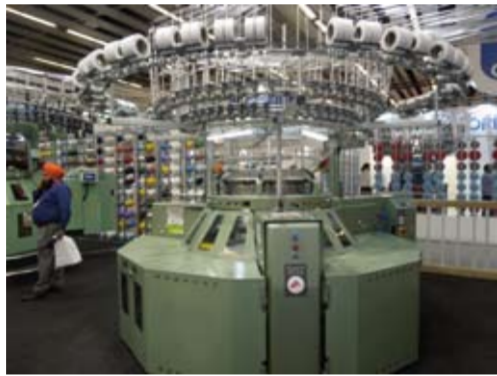
福原产业贸易公司在此前举行的ITMA 2019中，展示采用了自动开布卷取新型OD框架的新型圆编机。
