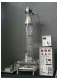
测定器使用测定接触冷感性的 q-max 的精密快速热物性测定装置。
